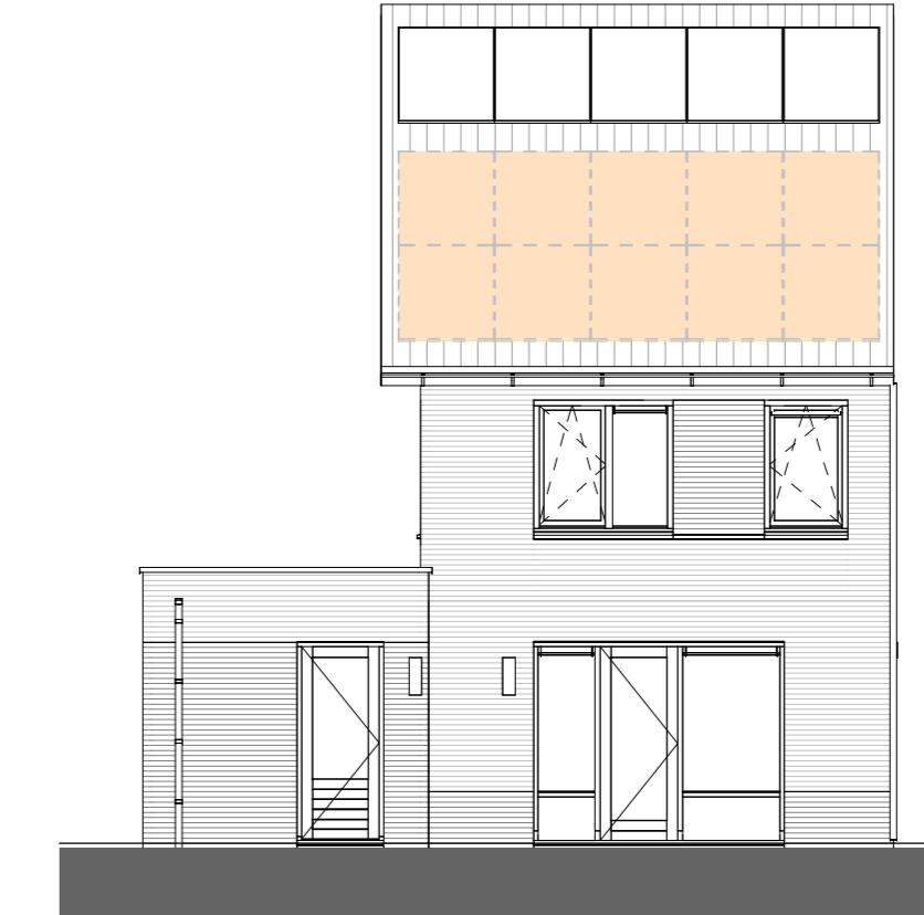
Achtergevel 1:100 Disclaimer: PV-panelen (zonnepanelen) achtergevel uitsluitend van toepassing op bouwnummer 01, 05, 06, 11, 12 en 14.
